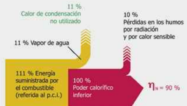
Rendimiento de una caldera convencional funcionando en instalación con temperaturas ida/retorno de 75/60°C
